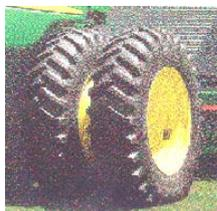
**Спаренные колеса** – Используют колеса, более узкие, чем базовые. Например, для машин класса Дон-1500Б размер базовых ведущих колес 0150 – 30,5 x 32, спаренных – 2x18,4x36 или 2x20, 8x38. Для создания зазора между спаренными колесами их монтируют на специальных дисках (с «тольпанам») или используют проставку (что это такое?) между стандартными дисками. Однако спаренная конструкция хороша только на ровных полях, иначе может сломаться мост.
