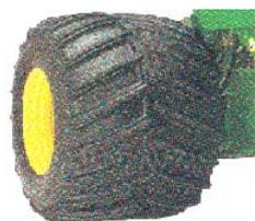
**Широкие колеса** – На неровных полях используют широкие шины (в 1.5 раза шире базовых). Ими оснащаются, как правило, только мост ведущих колёс.
