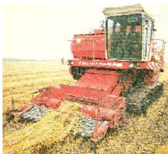
**Гусеничный ход** – Используется при комбайнировании на переувлажненных полях (пример, в Хабаровском крае). Требует некоторых изменений в конструкции рамы молотилки (подрессоривание подвески каретки), ведущего моста (фрикционный механизм поворота) и рулевого управления.
